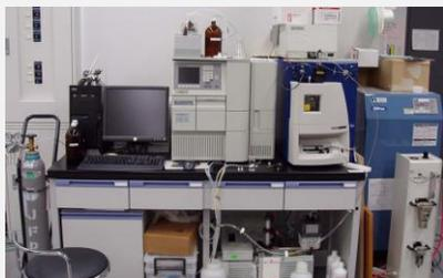
【特徴】液体有機物の混合物試料を、大きさ・吸着力・電荷・質量・疎水性などの違いを利用して、物質を成分ごとに分離するクロマトグラフィー部と、更に質量ごとに分離する質量分析計を組み合わせた装置で、物質の成分を高感度で分析できる。
