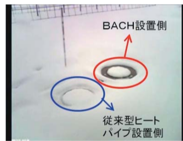
大野市防火水槽での融雪状況
