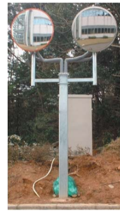
地中熱交換用BACHユニットによる防滴ミラーの試作
